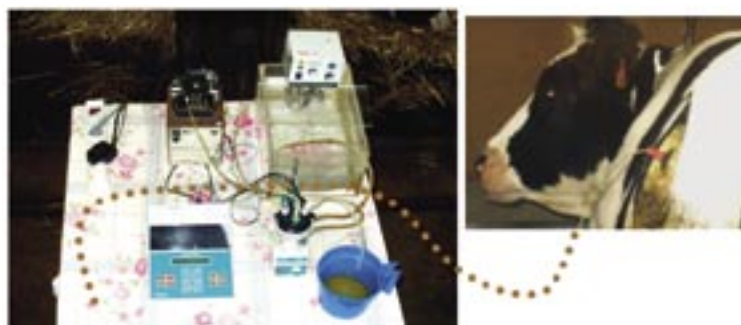
Figura 1. Desarrollo de una nueva metodología in vivo para evaluar el impacto de diferentes productos de levadura sobre el pH ruminal, potencial Redox del rumen y presencia de oxígeno en el rumen. Bayourthe et al. 2004, ENSAT. Francia.
